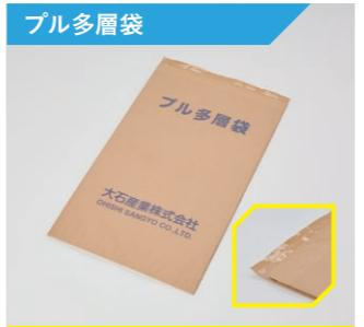
封筒状の袋で開口部にホットメルトを塗布しており、充填後、熱風により再活性させ折り返して封緘します。封緘時にミシン糸等の副資材が不要です。
