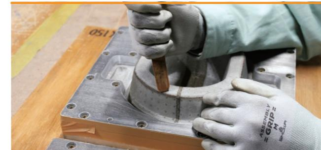
当社は製品設計～金型設計・作製～試作～量産まで全て自社で一貫対応しています。お客様からのご依頼に合った最適な緩衝設計を、設計のプロである専門スタッフが行います。金型も専用マシンにより内製化を実現し、お客様のご要望にスピーディに対応します。
