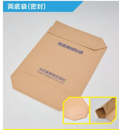
両側の底部を糊貼りした袋で、バルブ口から吹き込みにて充填を行います。密封性が高く、微粉末の包装に適しています。また、底部にカットテープをつけて開封機能を付与することも可能です。
